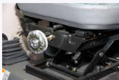
gefederter Komfortsitz mit Sicherheitsgurt und individueller Anpassung an das Fahrergewicht
