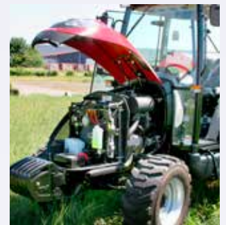
einfaches Öffnen der großen Motorhaube für leicht zugängliche Wartungsarbeiten
