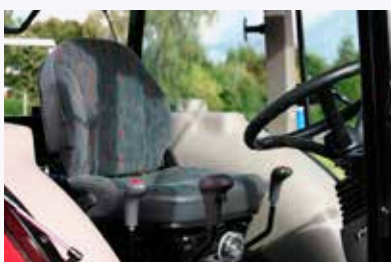
gefederter Komfortsitz mit Sicherheitsgurt und individueller Anpassung an das Fahrergewicht
